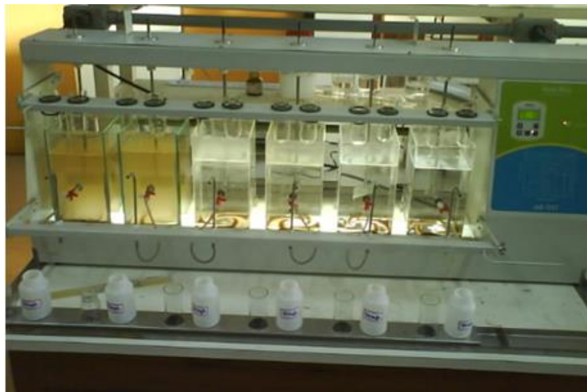
Figura 12- Equipamento Jartest utilizado para simular o tratamento por clarificação
