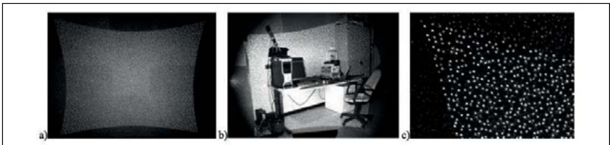
Figura 3 – Projeção de pontos em uma parede (a), uma cena genérica (b) e uma visão aproximada (zoom) do padrão de pontos projetados (c).
