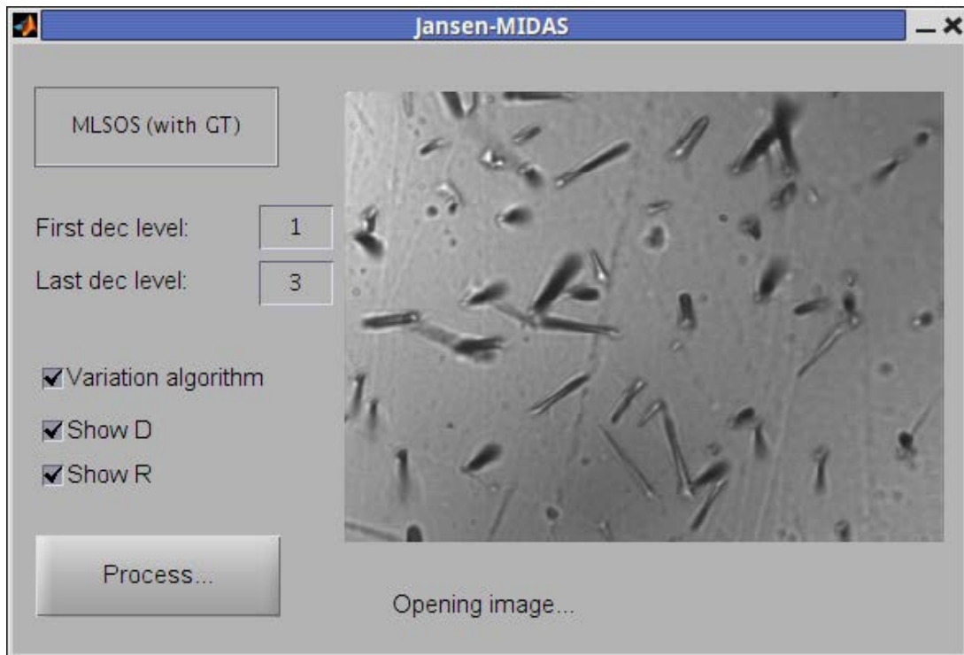
Figura 14 – A interface do Jansen-MIDAS correspondente à aplicação da MLSOS, níveis de segmentação inicial e final iguais a 1 e 3 respectivamente, uso do algoritmo MLSS variante e exibição dos níveis de detalhe wavelet ( D ) e de segmentação ( R ).
