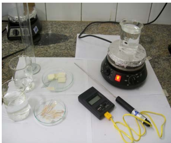
(a) Membranas de borracha natural a serem inseridas em água destilada para que seus poros se expandam.
