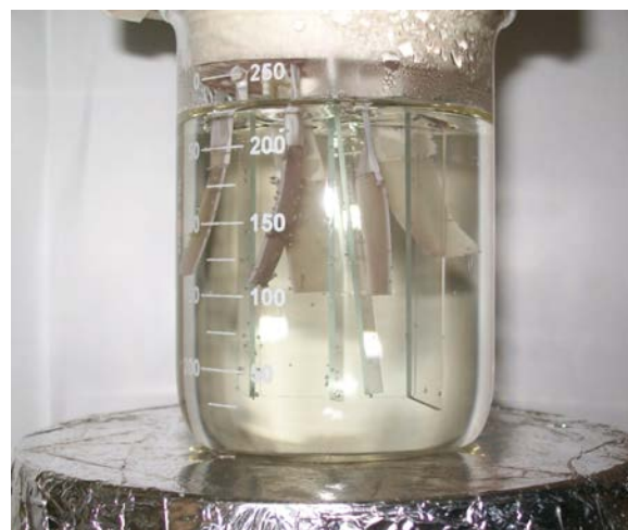
(b) Solução de AuCl_3 contendo as membranas de borracha natural.
