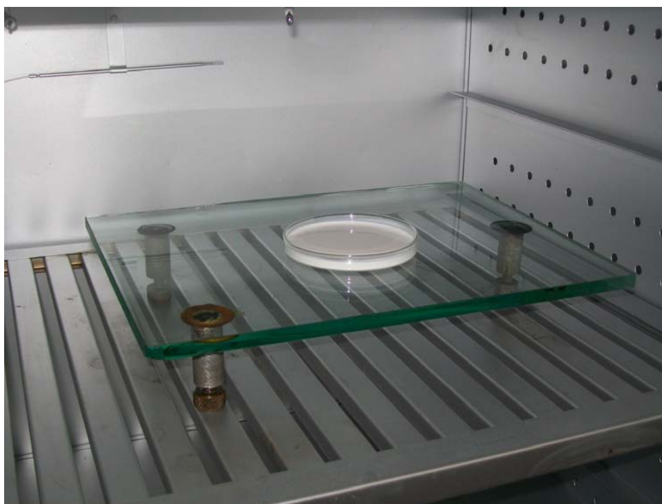
Figura 1 – Membrana de borracha natural confeccionada a partir do látex da árvore Hevea brasiliensis , clone RRIM 600, e estabilizada em amônia. A amostra é então depositada pela técnica de casting e submetida a tratamento térmico.
