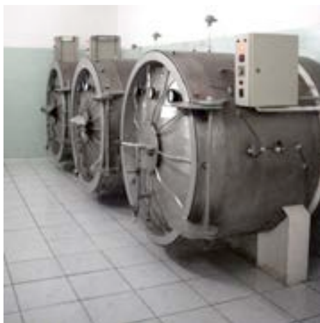
Figura 7 – Equipamento utilizado para esterilização por meio de óxido de etileno.
