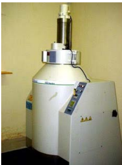
Figura 6 – Irradiador utilizado para a esterilização por irradiação gamma.
