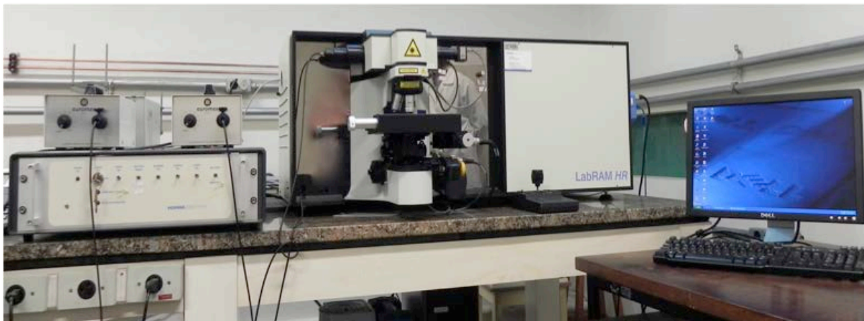
Figura 3 – Espectrômetro utilizado nas análises Raman.
