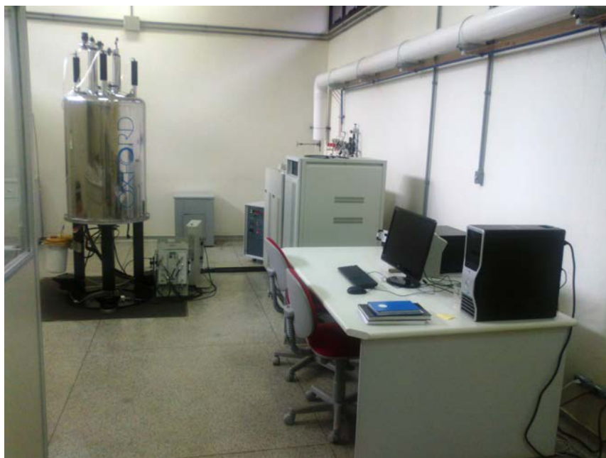
Figura 11 – Espectrômetro utilizado para a realização da análise de RMN.
