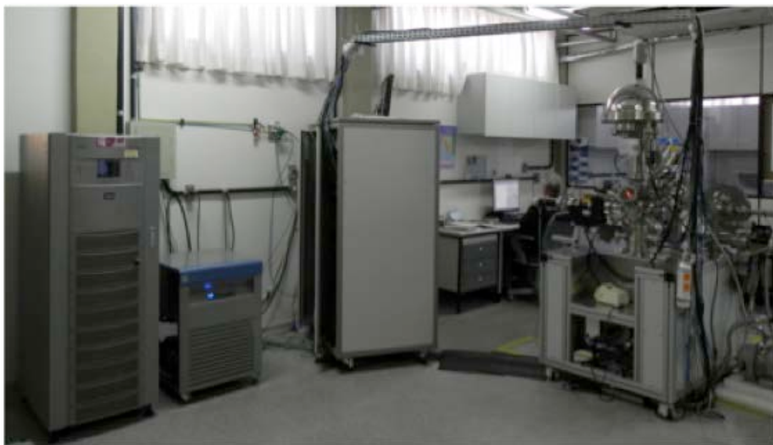
Figura 4 – Espectrômetro utilizado nas análises XPS.
