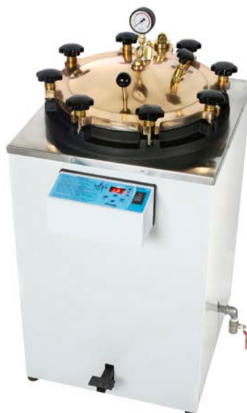
Figura 8 – Autoclave utilizada no procedimento de esterilização.
