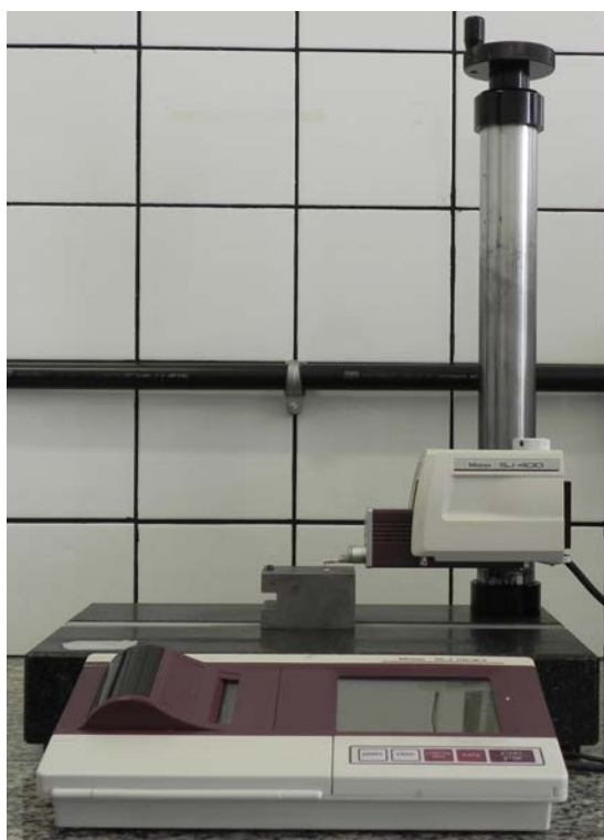
Figura 14 – A - Rugosímetro utilizado para as medidas de rugosidade.
