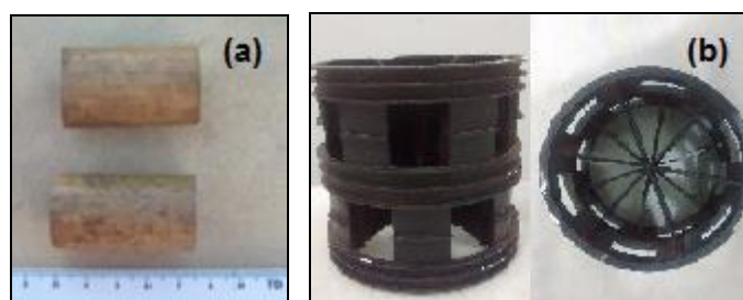
Figura 4. Fotos do bambu (a) e anéis de polipropileno (Bioring®) (b) utilizados como meio suporte nos reatores anaeróbios horizontais de leito fixo e alta taxa.
