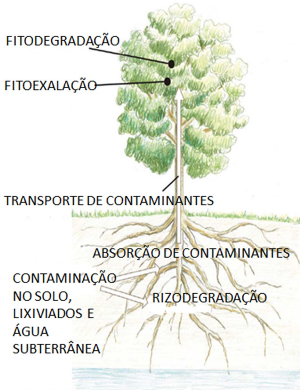
Figura 3. Processos que envolvem o transporte de contaminantes em plantas (Adaptado de VROBLESKY, 2008).
