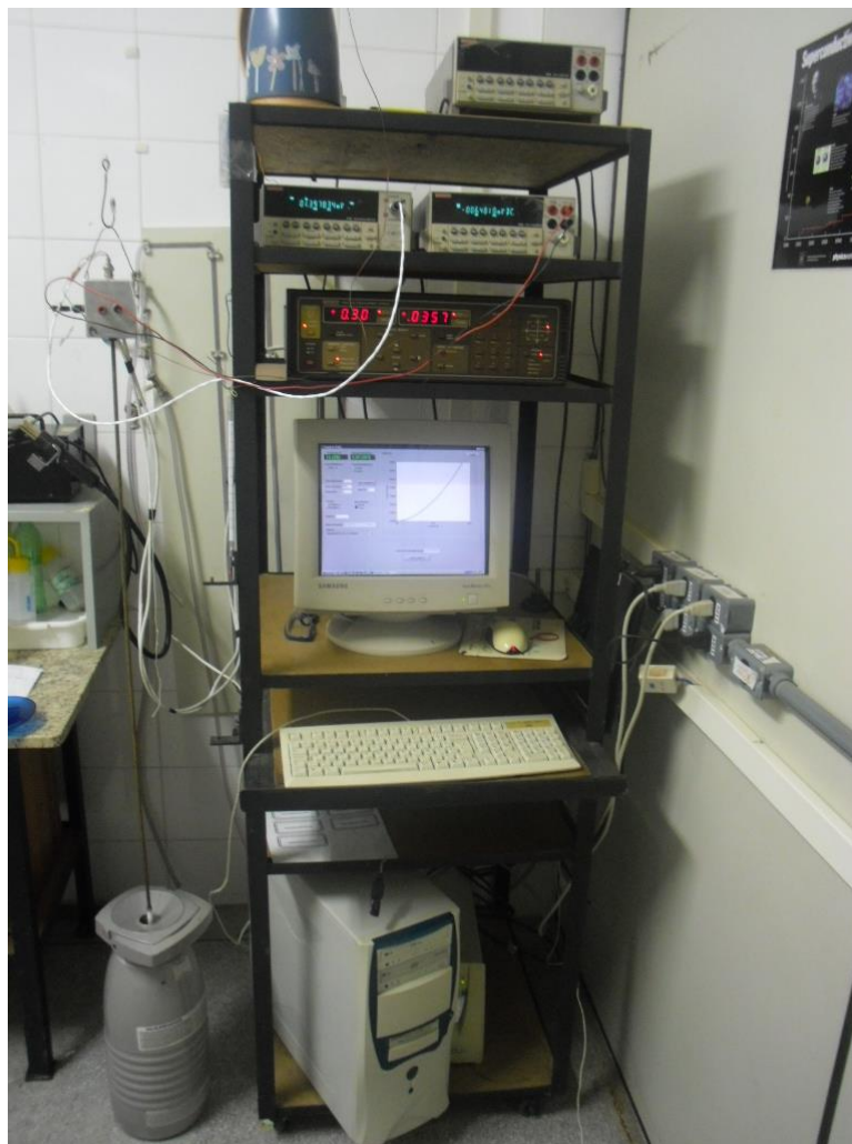
Figura 31 – Sistema utilizado para caracterizações elétricas em baixas temperaturas.
