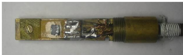
Figura 32 – Dedo frio utilizado para caracterização através do método de quatro pontas dc .
