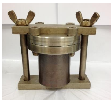
Figura 1. Foto da autoclave utilizada para as reações de carbonização hidrotérmica.
