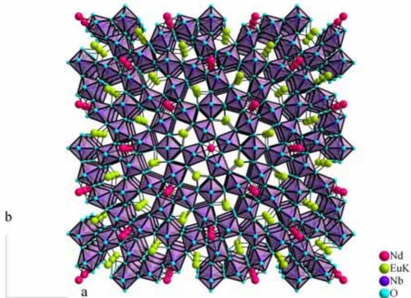
Figura 29. Representação esquemática da estrutura tungstênio bronze do KNNEu005.
