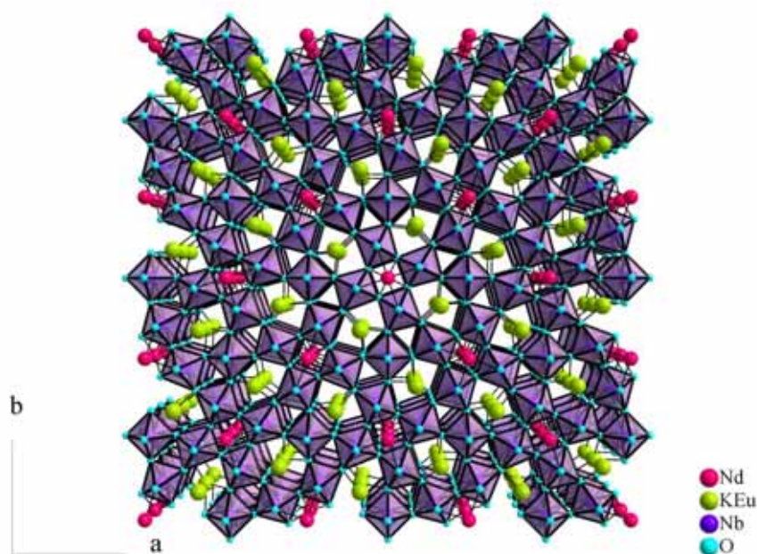
Figura 30. Representação esquemática da estrutura tungstênio bronze do KNNEu01.
