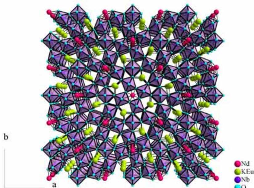
Figura 27. Representação esquemática da estrutura tungstênio bronze do KNNEu00025.
