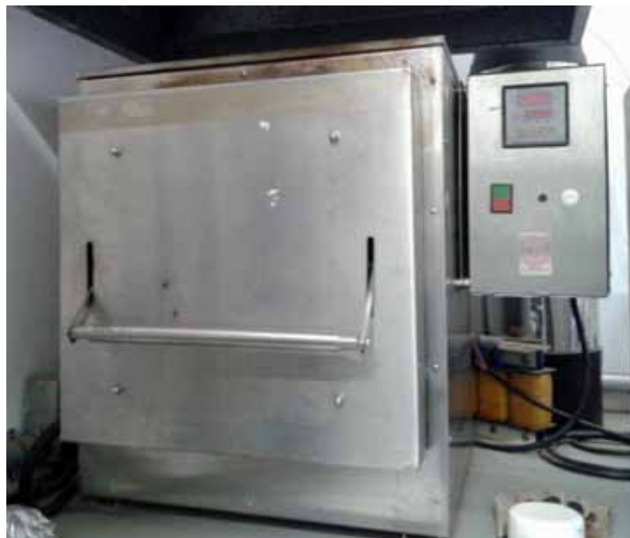
Figura 4. Forno utilizado para a pré-calcinação dos precursores do KNN e das soluções sólidas de KNNEu00025, KNNEu0025, KNNEu005 e KNNEu01.
