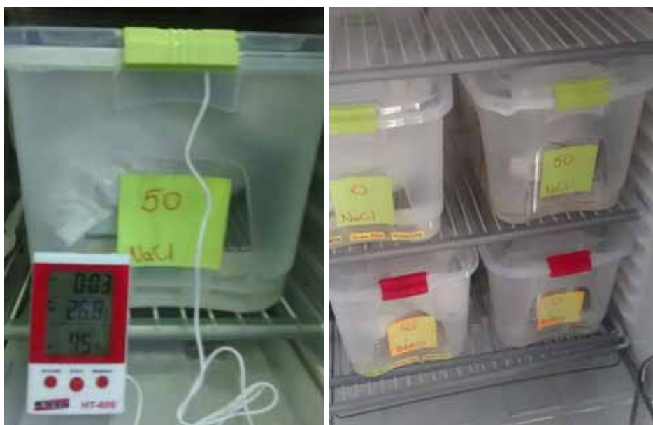
Figura 3.10: Caixas plásticas de armazenamento das vagens de amendoim em umidade e temperatura do ambiente controlada com NaCl e BaCl 2
