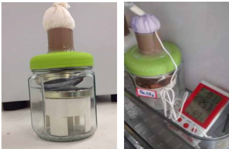
Figura 2.6: Frasco juntamente contendo as peneiras com as vagens e o suporte; medidor de umidade relativa (Termo-higrômetro digital Modelo HT – 600)
