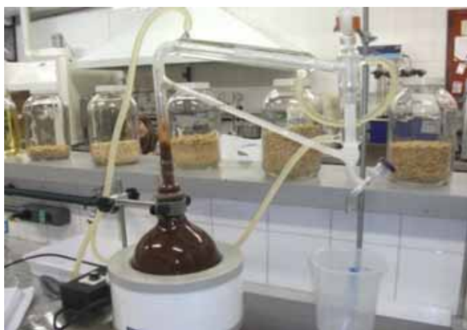
Figura 2.5: Destilador de óleos essenciais (hidrodestilador Clevenger)
