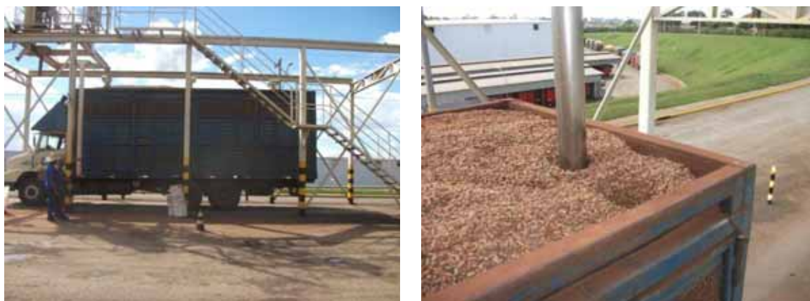
Figura 1.5: Coleta de amostras na recepção por sonda mecânica
