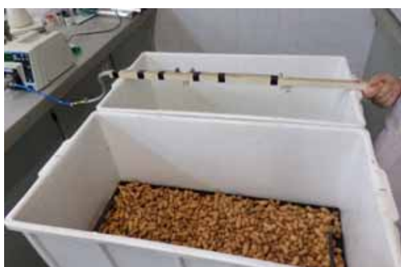
Figura 3.7: Imagem das caixas do experimento calibração do volume aspergidos (a), aspersores sobre as vagens de amendoim.
