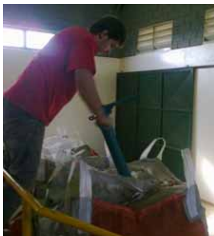
Figura 1.7: Coleta de amostras no armazenamento, no 3º Mês, com o auxílio de amostrador de fases
