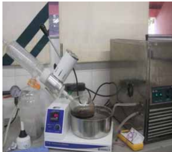
Figura 2.4: Filtro a vácuo e rotoevaporador nas extrações aquosa e alcoólica
