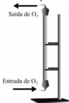
Figura 17. Montagem da coluna para a utilização de fluxo constante de ozônio em coluna.
