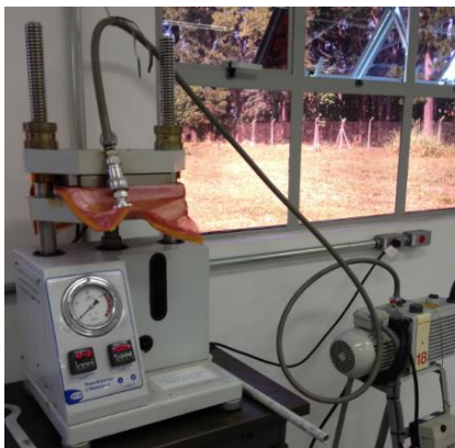
Figura 34 ó Sistema de cura em prensa a quente.
