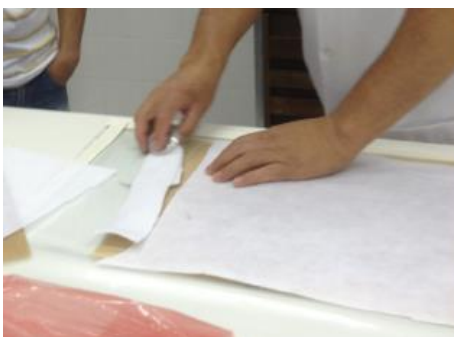
Figura 31 ó Camada de tecido canalizador.
