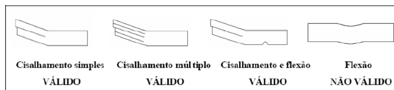
Figura 19 ó Modos de falhas possíveis em amostras ensaiadas pelo método de cisalhamento interlaminar em três pontos ( short beam ).
