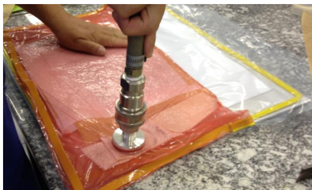
Figura 33 ó Sistema de vácuo acoplado na bolsa de vácuo.
