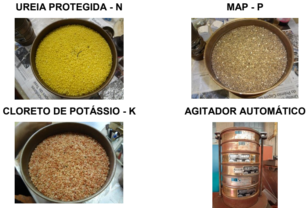
Figura 14. Granulometria de ureia protegida (nitrogênio - N), MAP (fósforo – P) e cloreto de potássio (potássio - K) retidos na peneira de 2,000 mm e o agitador automático.
