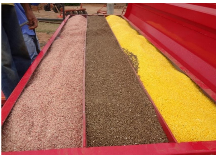
Figura 7. Divisões no reservatório da adubadora para os nutrientes (N, P e K).
