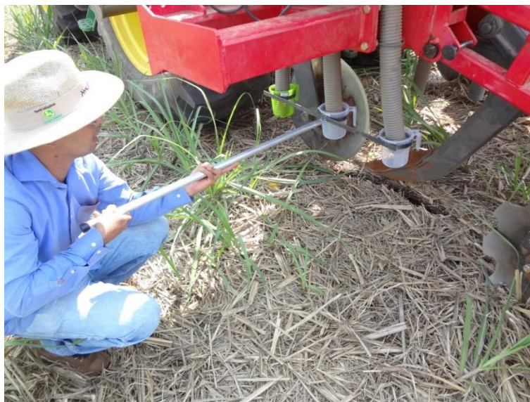
Figura 6. Ferramenta utilizada para coleta de adubo (doses de N, P e K).
