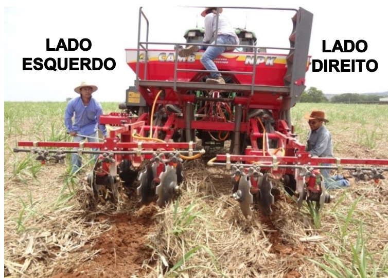
Figura 8. Coleta de cada nutriente em ambos os lados (esquerdo e direito) da adubadora.
