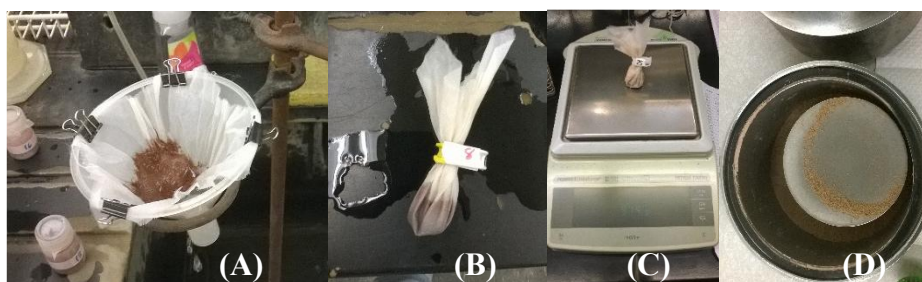
Figura 4. Filtragem das amostras (A), filtros com amostra de solo (B), pesagem das amostras secas a 50°C por 24 h (C) e amostras após moagem (D).
