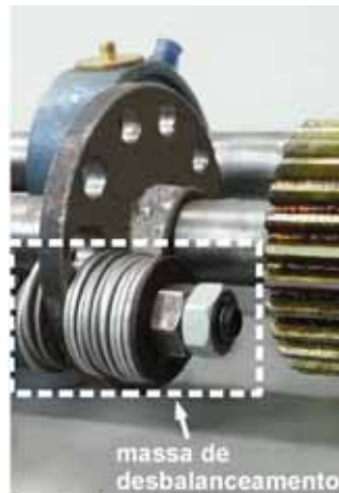
Figura 14 – Massa de desbalanceamento adicionada ao disco
