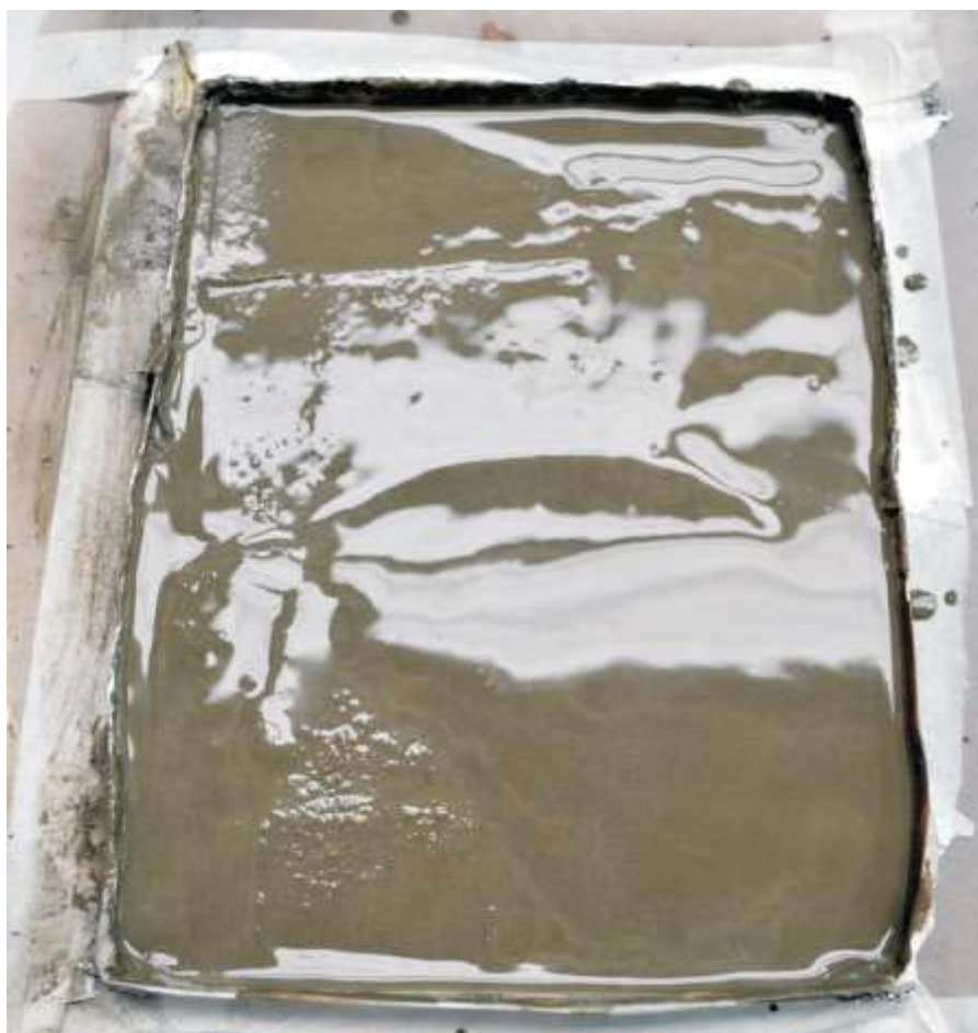
Figura 123 – Preparo e Enchimento da fôrma - 2014.
