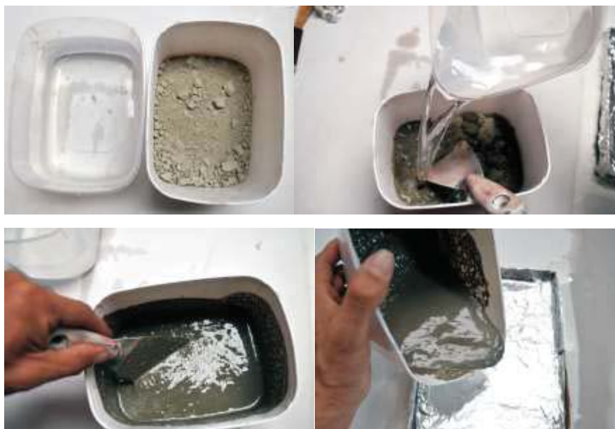
Figura 122 – Preparo e Enchimento da fôrma - 2014.
