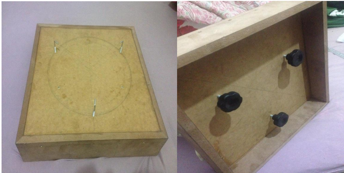
Figura 5: Acélula vista de cima com as pinças (esquerda) e de baixo, mostrando os parafusos de colimação com as manoplas (direita)
