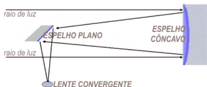
Figura 1: esquema óptico de um telescópio refletor newtoniano
