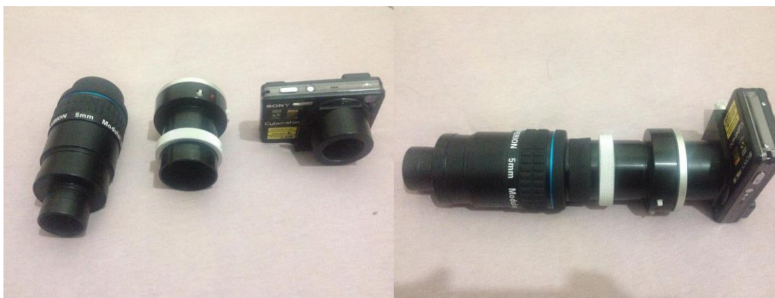
Figura 12: periféricos: a ocular de 5mm, o redutor focal e a câmera. A direita, o conjunto montado.
