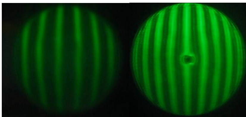
Figura 10: ronchigrama feito após a ferramenta de 250mm (esquerda) e após a ferramenta de 150mm (direita). Ambas imagens são satisfatórias, mostrando que mesmo antes do polimento estar completo, o espelho já apresenta boa refletividade.
