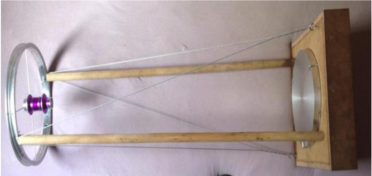
Figura 8: Conjunto montado, mostrando da esquerda para a direita o anel de captação de imagens, a estruturas string / truss e a célula do primário.
