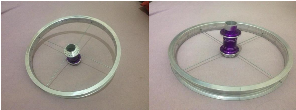
Figura 6: o anel - suporte para o equipamento de captação de imagens feito de uma roda de bicicleta aro 16 e um cubo rolamentado.
