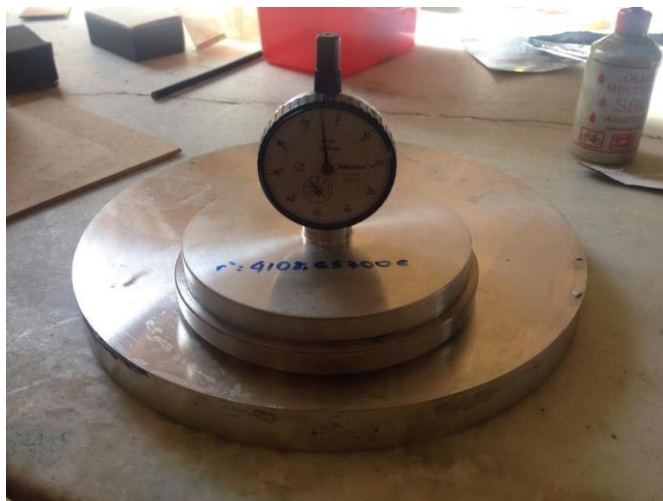
Figura 9: espelho com esfêmetro (instrumento de medida de esfericidade) mostrando a curva gerada.
