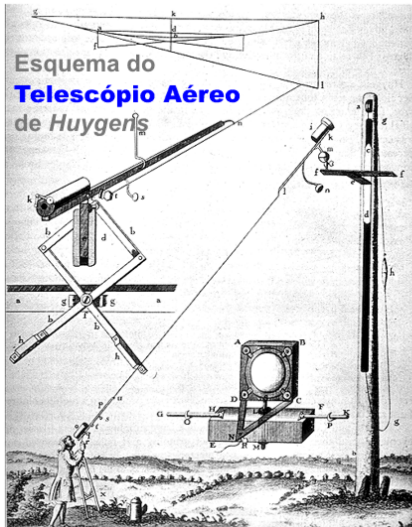
Figura 7 - Esquema Ilustrativo do telescópio de Huygens. Ref [15]
