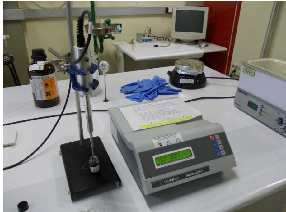
Figura 11: Ponta ultrassônica utilizada para desagregar as micro-partículas de Zn_2SiO_4:Mn na blenda polimérica em solução.
