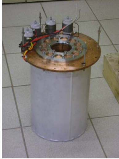
Figura 8: Magneto supercondutor feito com uma liga de Titânio-Nióbio utilizado no sistema Tesla-tronPT para produzir campos magnéticos de até 12T, na parte superior do magneto estão os cabos para a alimentação e os pinos para o posicionamento adequando do magneto dentro do criostato para não haver deformação das linhas de campo.
