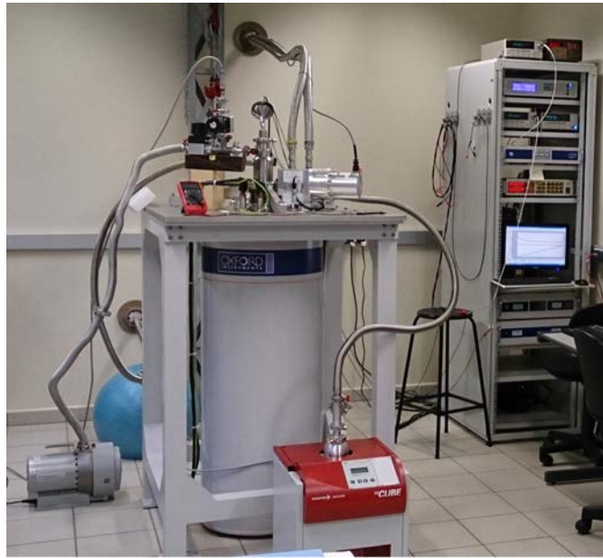
Figura 6: Ao centro o criostato TeslatronPT da Oxford utilizado nos experimentos de baixas temperaturas. A frente a bomba de vácuo HiCube que atinge pressões de até 10^{-6} mbar. Ao fundo o rack com os equipamentos utilizados para os experimentos.
