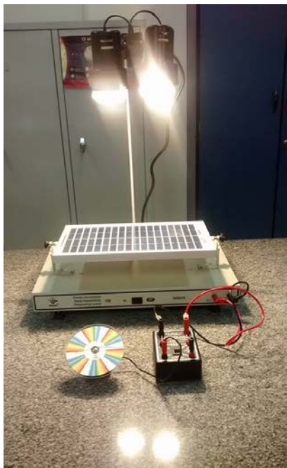
Figura 6. Placa solar com disco de Newton.
