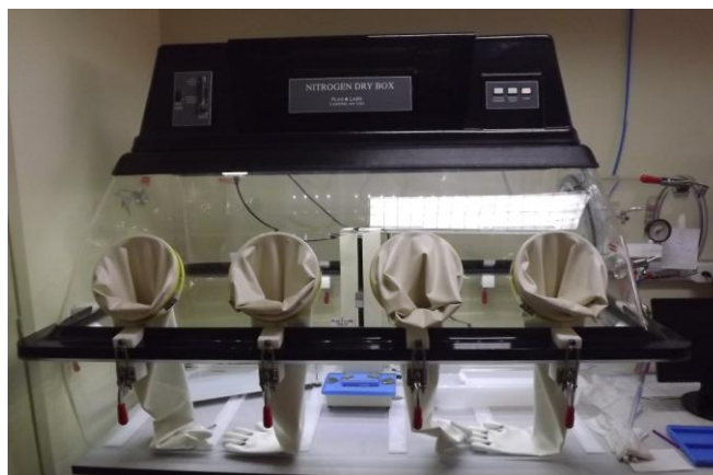
Figura 4.2 – Fotografia da Glove-Box com o equipamento de dip-coating utilizado para síntese dos filmes finos.
