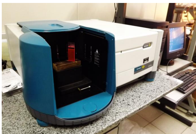
Figura 5.6 – Fotografia do espectrofotômetro de fluorescência Varian Cary Eclipse utilizado com computador para a aquisição de dados.
