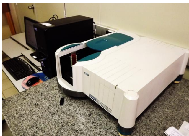
Figura 5.3 – Fotografia do espectrofotômetro de absorção UV/VIS Varian Cary 50 utilizado com computador para aquisição de dados ao fundo.
