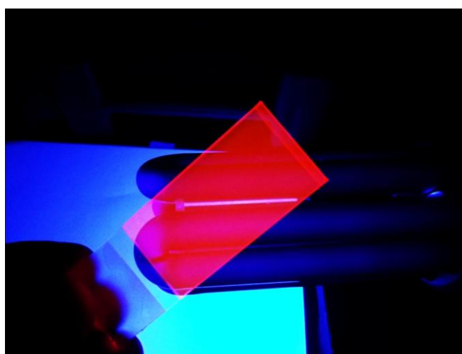
Figura 6.6 – Fotografia de filme fino Híbrido de Sílica/Orgânico a base de GPTS-TEOS dopado com Rodamina-B durante excitação por luz ultravioleta (Luz Negra comercial \lambda \approx 470\text{nm} ). As propriedades de luminescência da Rodamina-B são mantidas no filme.
