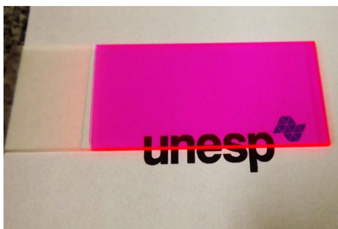
Figura 6.5 – Fotografia de filme fino Híbrido de Sílica/Orgânico a base de GPTS-TEOS dopado com Rodamina-B. O filme depositado sobre lâmina de vidro apresenta excelente qualidade óptica.
