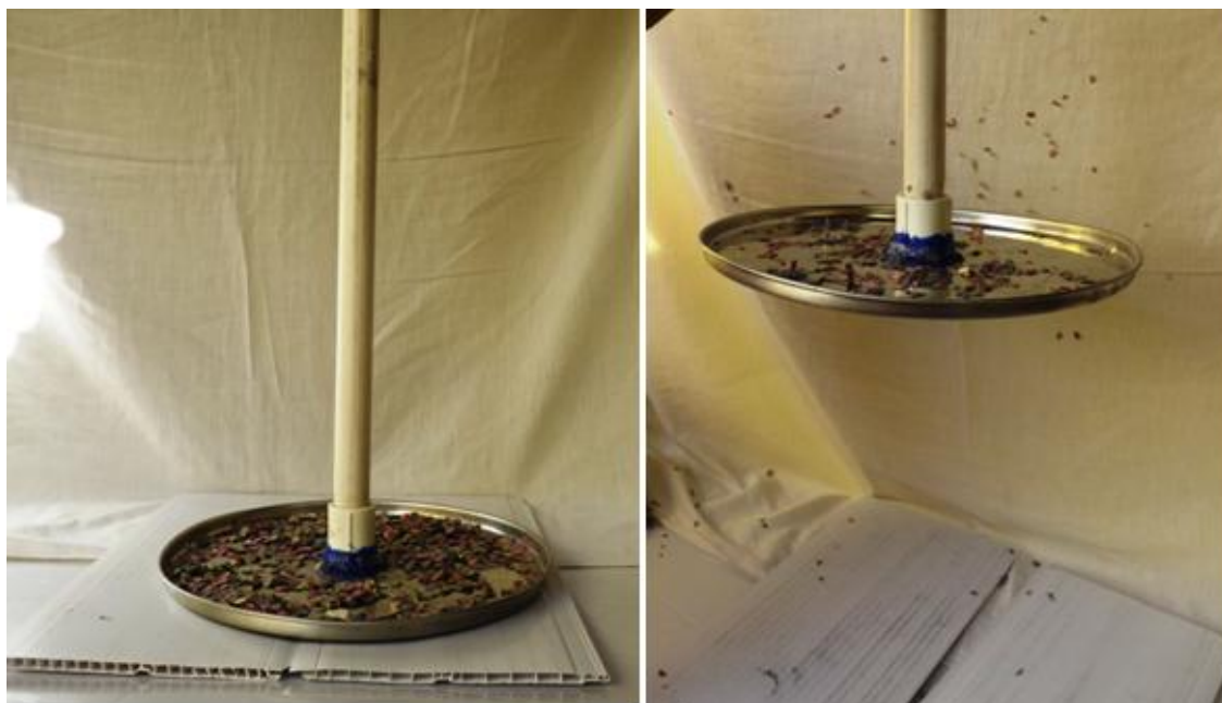
Figura 6 Eletróforo com a montagem utilizada nesse trabalho
