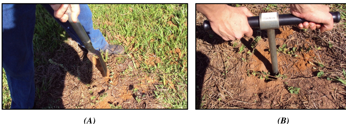
Figura 24: Perfuração do solo (A) e profundidade do furo (B) utilizando o trado manual. Fonte: Fotografia “in situ” tirada em Regente Feijó.
