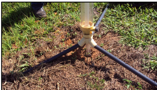
Figura 25: Encaixe do Permeômetro de Guelph no solo. Fonte: Fotografia “in situ” tirada em Regente Feijó.
