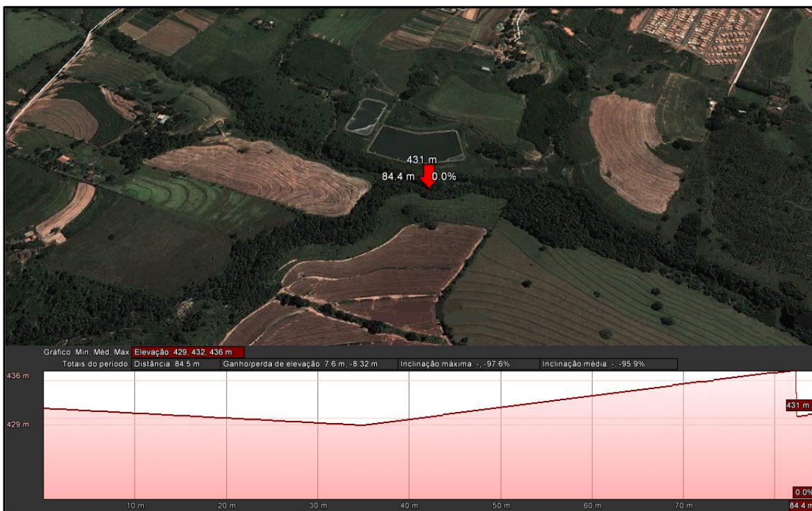
Figura 17: Perfil de elevação do relevo, do ponto de saída da lagoa até o corpo hídrico – Regente Feijó. Fonte: Google Earth ®
