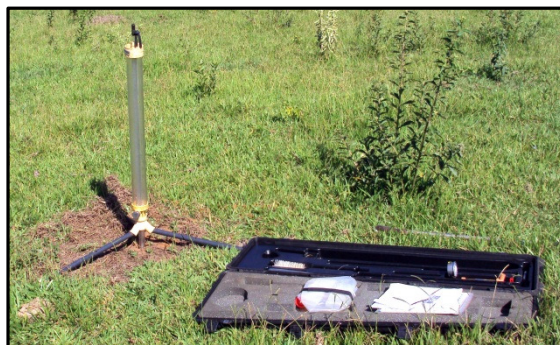
Figura 26: Permeômetro de Guelph. Fonte: Fotografia “in situ” tirada em Regente Feijó.
