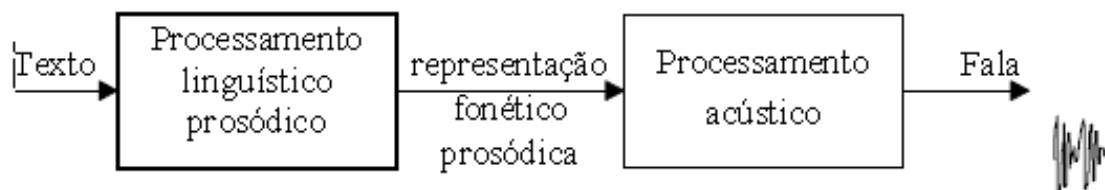
Figura 3 - Blocos de processamento de um Sistema TTS
