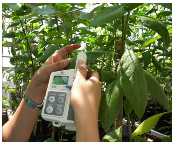
Figura 9. Avaliação do teor relativo de clorofila com o auxílio de clorofilômetro.
