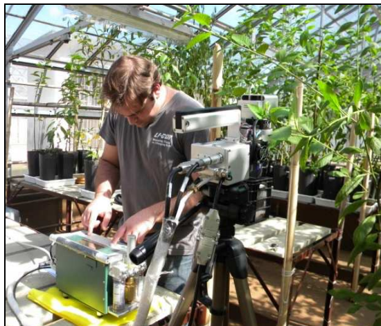
Figura 10. Análise das trocas gasosas com o uso de analisador de gases portátil.
