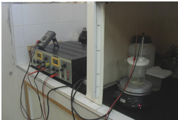
Figura 14 - Montagem experimental para anodização eletroquímica.
