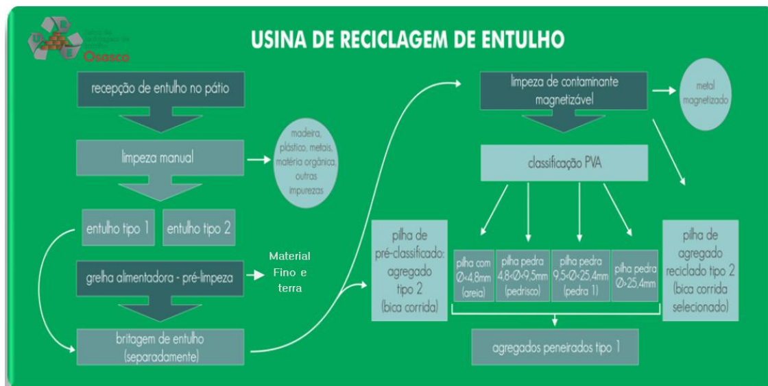
Figura 15 – Fluxo de trabalho da Usina de Reciclagem de Entulho de Osasco
