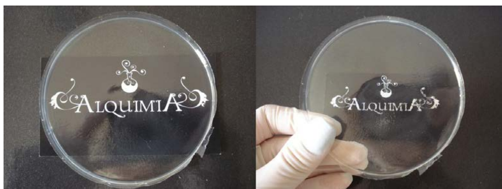
Figura 23: Transparência do filme de fibroína com PEG 200 g/mol, rente e afastado da superfície.
