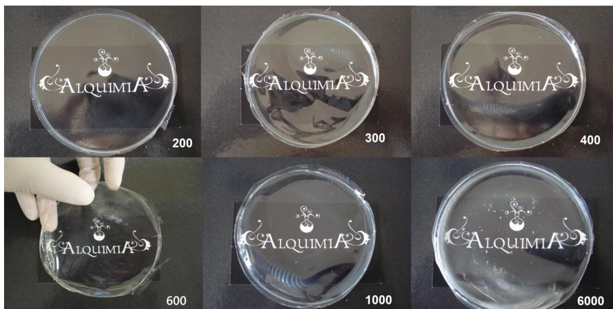
Figura 22: Filmes de fibroína com 30% de PEG, com diferentes MM (g/mol).
