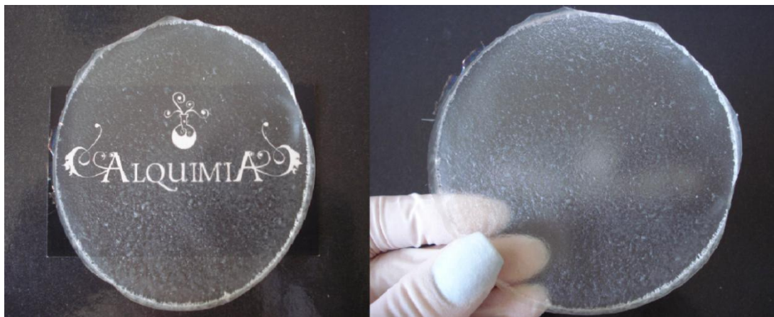
Figura 10: Transparência do filme de fibroína com 5,0% de fibras de CB, rente e afastado da superfície.
