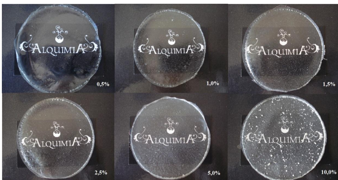
Figura 8: Filmes de fibroína com fibras de CB utilizadas como reforço em diferentes proporções.
