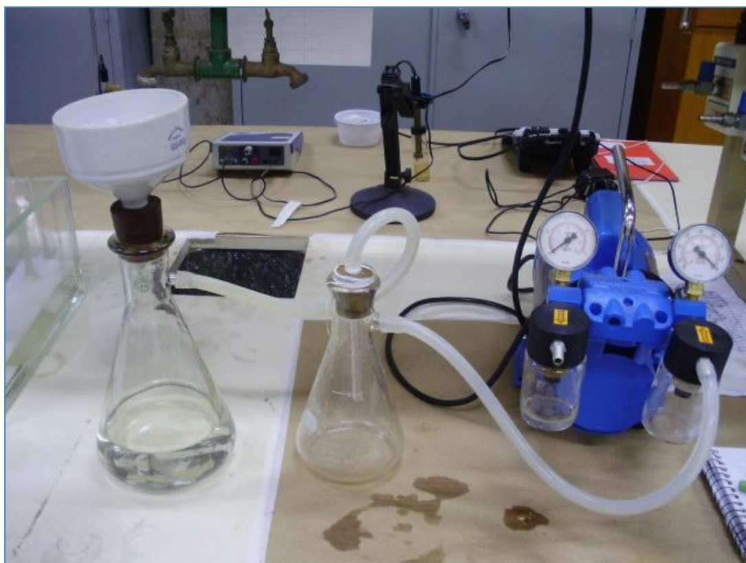
Figura 16: Esquema de filtração à vácuo da água do rio Jacaré-Guaçu.
