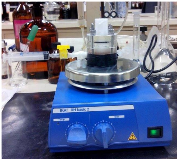
Figura 1- Amostrador de microextração líquido-gás-líquido montado sobre um agitador magnético.
