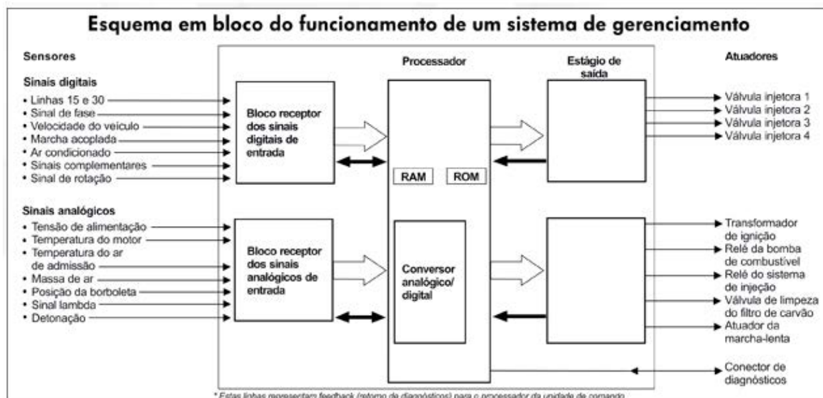
Figura 2.11 – Diagrama de blocos, sistema gerenciamento eletrônico. [42]
