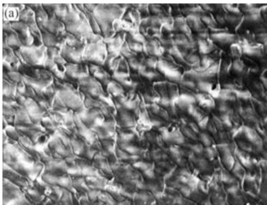
Figura 2.5 – MEV Substrato YSZ sinterizado a 1773 K.
