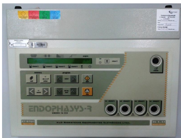
Figura 5 – Aparelho Endophasys – R KLD® utilizado na estimulação elétrica.
