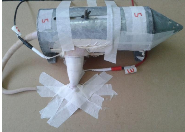
Figura 6 – Cápsula metálica usada para a eletroestimulação.
