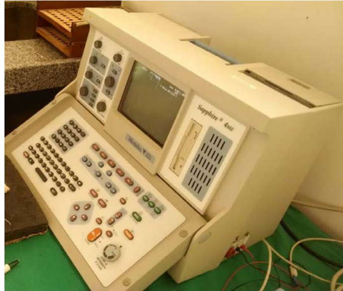
Figura 7 – Eletromiógrafo da marca Sapphire II 4ME utilizado para as análises.
