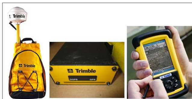
Foto 5.4: Sistema de posicionamento Global: Antena DGPS Trimble; receptor Navigation Pathfinder Pro XR 12 e coletor Recon respectivamente.
