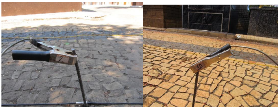
Foto 5.1: Adaptação de eletrodos para a utilização no piso de “Pedra Portuguesa” Foto 5.2: Idem.
