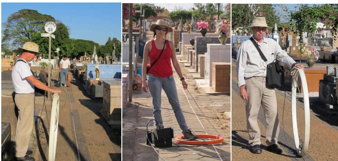
Fotos 5.5: Equipamento EM-34 composto por duas bobinas (transmissora e receptora). Um módulo de controlo e emissão de corrente elétrica e um módulo de leitura.
