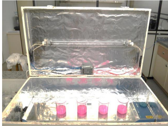
Figura 13: Montagem do experimento de fotodegradação de corante. Fonte: o autor.
