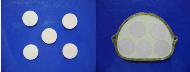
FIGURA 1 - Matrizes confeccionadas em silicóna laboratorial de condensação / Matrizes de silicóna incluídas em mufra
