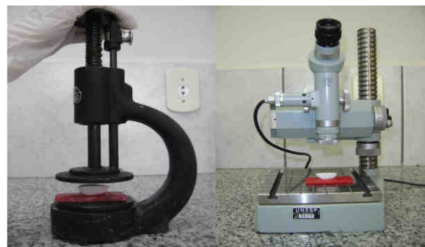
FIGURA 9 – Espécime de gesso no paralelômetro/ Espécime de gesso no microscópio de mensuração
