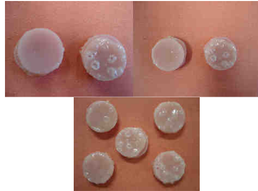
FIGURA 7 - Aspecto macroscópico / Corega@tabs e bicarbonato de sódio (A)/ hipoclorito de sódio e bicarbonato de sódio (B)/ bicarbonato de sódio (C)
