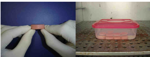
FIGURA 5 - Disco de resina acrílica ativada termicamente recoberto por reembasador resiliente acrílico. Espécimes estocados em saliva artificial a 37 \pm 1^\circ\text{C}
