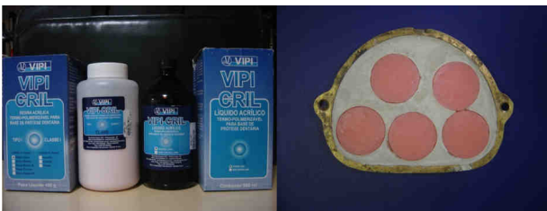
FIGURA 2 – Resina Acrílica Termoativada para construção dos discos de resina/Discos em resina acrílica após termpolimerização
