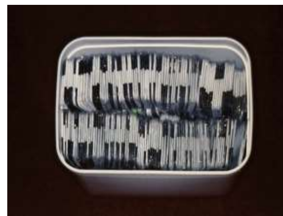
Figura 5. Filmes radiográficos embalados com filme PVC e acondicionados em pote plástico com tampas para conservação em geladeira.
