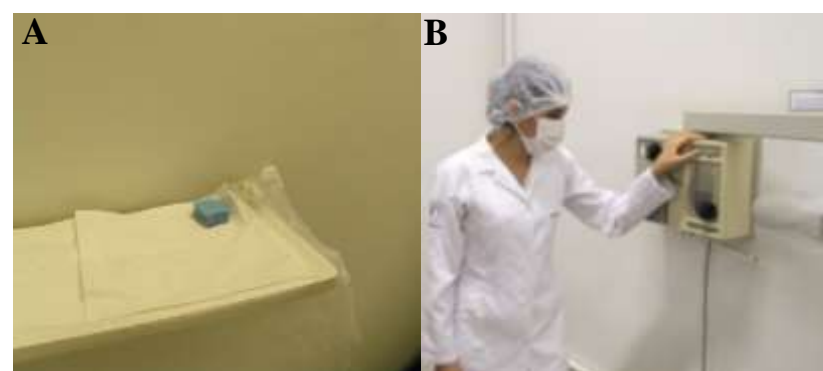
Figura 10. Bancada auxiliar contendo filmes radiográficos (A) e auxiliar realiza determinação do tempo de exposição para o desenvolvimento da técnica radiográfica (B).
