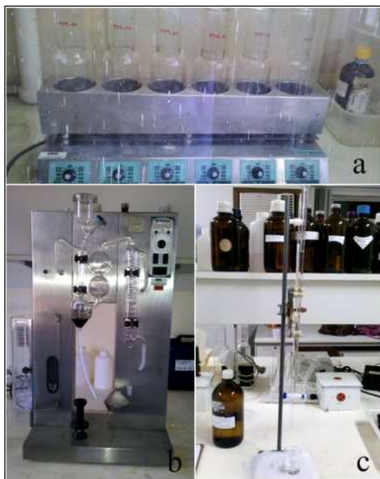
Figura 5.10. Processo de medição do nitrogênio total: a) digestão; b) destilação e c) titulação
