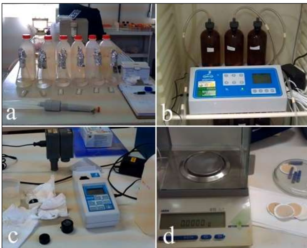
Figura 5.9. Equipamentos utilizados na determinação dos parâmetros para o IQA a) amostras sendo preparadas para análise dos Coliformes Totais e E. Coli ; b) equipamento BonkTrack utilizado para medir a DBO 5,20 ; c) aparelho turbidímetro da marca Hach; d) balança de precisão utilizada na pesagem dos resíduos de sólidos suspensos totais
