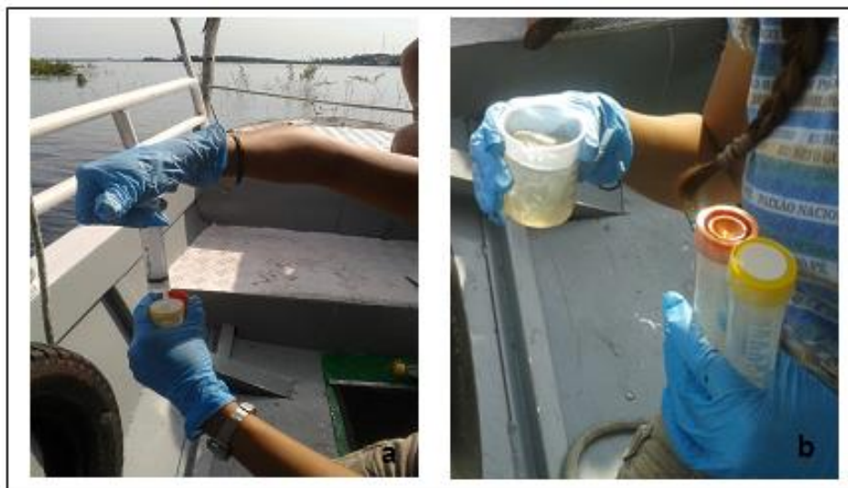
Figura 14. Procedimento adotado para coleta de amostras - a) Teor dissolvido; b) Teor total.
