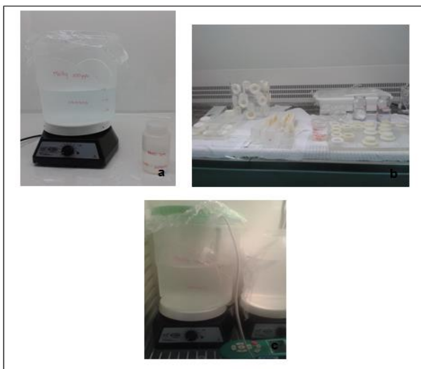
Figura 09. a) solução em estabilização; b) Dispositivos DGTs a serem utilizados para imersão; c) imersão dos DGTs.
