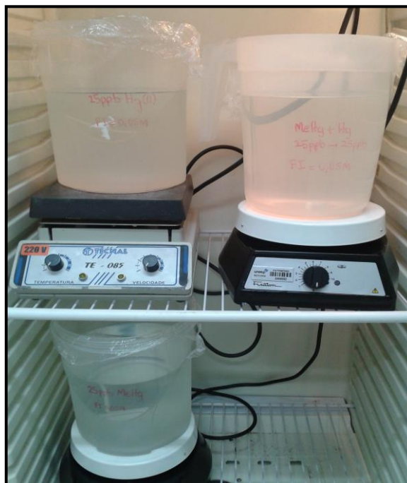
Figura 10. Soluções sintéticas de Hg (II) e MeHg para a análise de especiação.
