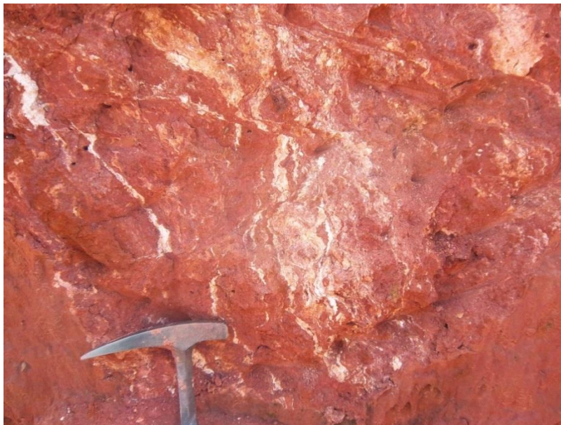
Figura 16 – Gnaiss saprolítico intensamente intemperizado, mostra cor avermelhada, marcada pela presença de argilas e hidróxidos de ferro, e resquícios de caulim, resultante da alteração de feldspatos. Afloramento IRF_MS1_02.
