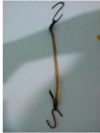
**Figura 2:** Balança de gancho.
