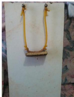
**Figura 3:** Balança com associação de tubos de látex em paralelo.
