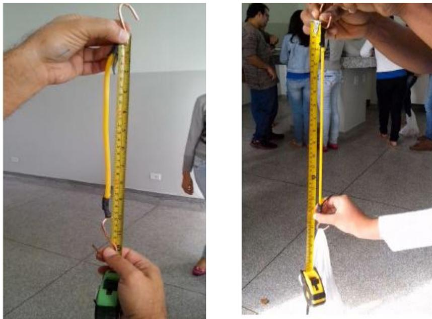
**Figura 6:** Procedimento experimental para obtenção da elongação do tubo de látex.
