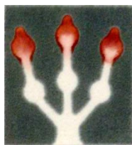
Figura 65 – Experimento para comprovar que o \text{Fe}^{3+} não fica adsorvido no papel e é arrastado pela amostra. Coloração avermelhada refere-se ao complexo de \text{Fe}^{3+} com tiocianato
