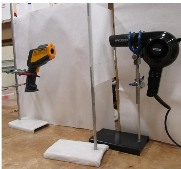
Figura 18 – Esquema utilizado para o estudo da temperatura de aquecimento em função do tempo
