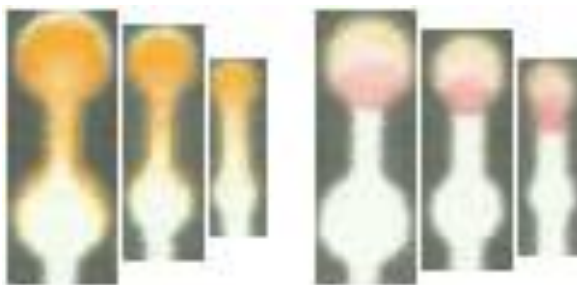
Figura 24 – À esquerda está ilustrado as zonas de teste para o analito creatinina e à direita para o ácido úrico. Os três diâmetros de zona são 3, 4 e 5 mm
