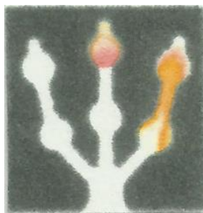
Figura 10 – \mu PAD utilizado para a detecção de ácido úrico (canal central) e de creatinina (canal à direita). A intensidade da coloração é mensurável por tratamento da imagem digital
