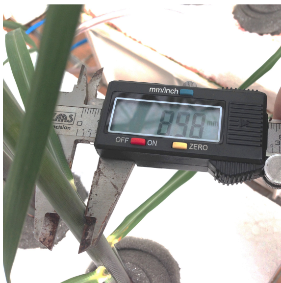
Figura 3. Determinação do diâmetro de colmo com auxílio de paquímetro digital.
