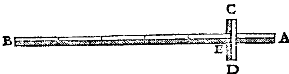
Figura 7: Báculo (Bartoli, Del modo di misurare , 5r)
