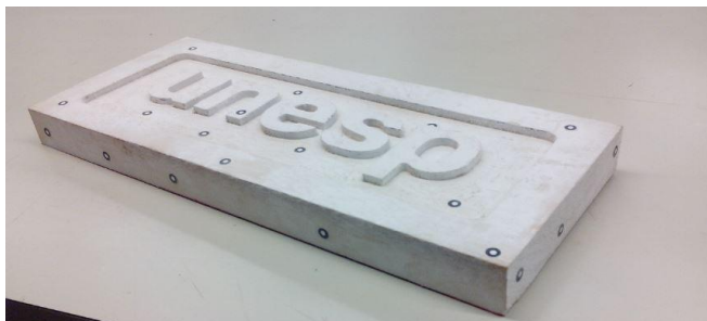
FIGURA 5 PEÇA FINAL USINADA PREPARADA PARA O SCANNER.
