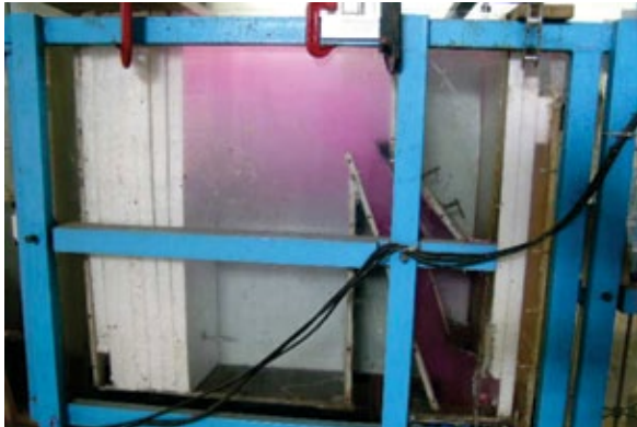
Figura 10 - Algumas das imagens dos ensaios com uso de traçador que envolveram a definição das condições de coleta da água flotada na unidade operando com modo convencional. Taxa de 200 \text{ m}^3 \cdot \text{m}^2 \cdot \text{d}^{-1} , p=0,10 , Td_{zc}=40\text{s} e a saída da água flotada feita
