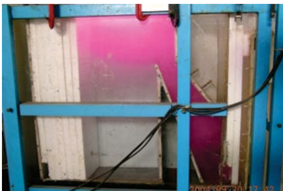
Figura 11 - Algumas das imagens dos ensaios de traçador que envolveram a definição das condições de coleta da água flotada na unidade operando no modo convencional. Taxa de 200 \text{ m}^3 \cdot \text{m}^2 \cdot \text{d}^{-1} , p=0,10 , Td_{zc}=90\text{s} e a saída da água flotada feita através placa com orifícios (dispositivo Tipo 2) localizada na porção inferior da zona de separação.
