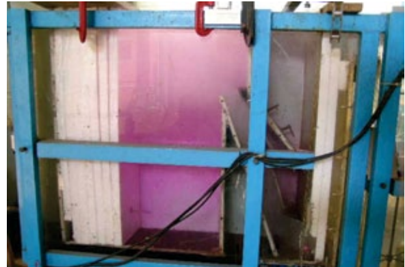
Figura 10 - Algumas das imagens dos ensaios com uso de traçador que envolveram a definição das condições de coleta da água flotada na unidade operando com modo convencional. Taxa de 200 \text{ m}^3 \cdot \text{m}^2 \cdot \text{d}^{-1} , p=0,10 , Td_{zc}=40\text{s} e a saída da água flotada feita
