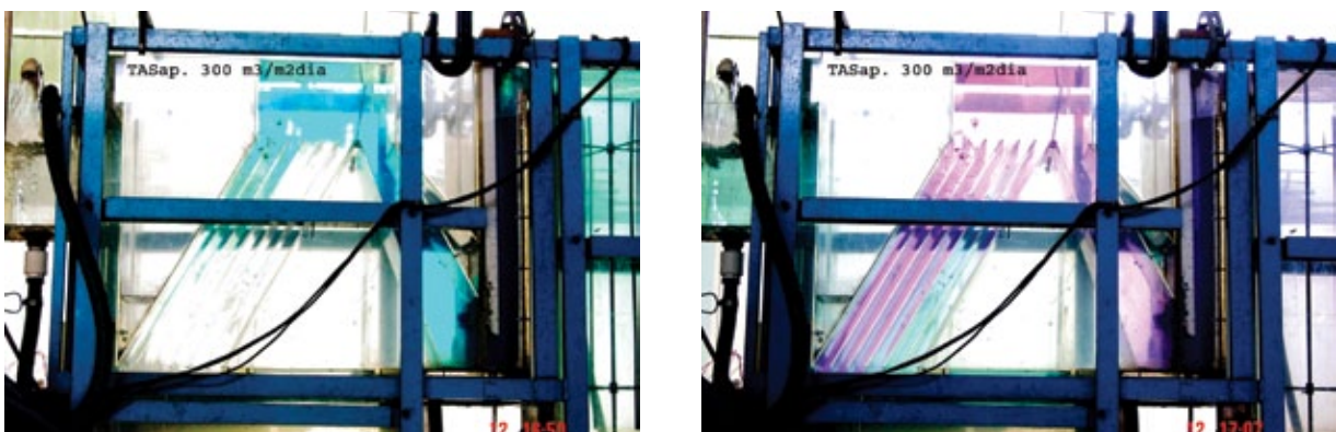
Figura 5 - Algumas das imagens dos ensaios com uso de traçadores mostrando a distribuição do escoamento de líquido entre as lamelas em dois momentos subsequentes da unidade operando no modo de alta taxa. Taxa de 300 \text{ m}^3/\text{m}^2.\text{d}^1 , p=0,1 e td_{zc}=90 e a saída feita através de tubulação perfurada localizada na parte superior da zona de saída da piloto (dispositivo Tipo 1).
