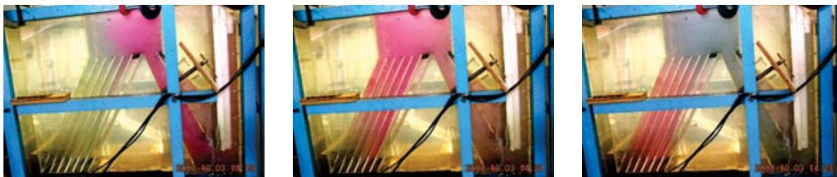
Figura 8 - Algumas das imagens dos ensaios com uso de traçadores mostrando a distribuição do escoamento de líquido entre as lamelas em três momentos subsequentes da unidade operando no modo de alta taxa. Taxa de 460 \text{ m}^3 \cdot \text{m}^2 \cdot \text{d}^{-1} , p=0,10 , Td_{zc}=40\text{s} e a saída de água flotada feita através placa com orifícios localizada logo abaixo do conjunto de lamelas (dispositivo Tipo 2).
