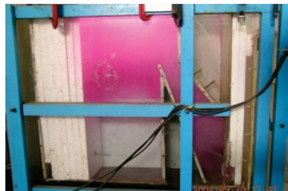
Figura 11 - Algumas das imagens dos ensaios de traçador que envolveram a definição das condições de coleta da água flotada na unidade operando no modo convencional. Taxa de 200 \text{ m}^3 \cdot \text{m}^2 \cdot \text{d}^{-1} , p=0,10 , Td_{zc}=90\text{s} e a saída da água flotada feita através placa com orifícios (dispositivo Tipo 2) localizada na porção inferior da zona de separação.
