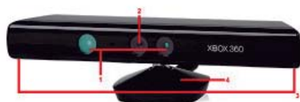
Figura 2 - O sensor Microsoft Kinect: 1) Sensor de profundidade; 2) Câmera RGB; 3) Conjunto de microfones; 4) Motor de inclinação.
