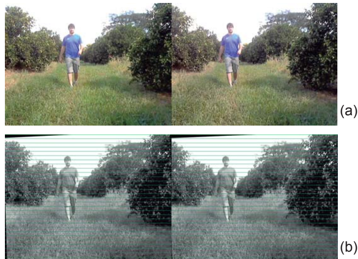
Figura 3 - (a) Imagens originais correspondentes direita e esquerda e (b) Imagens após retificação.
