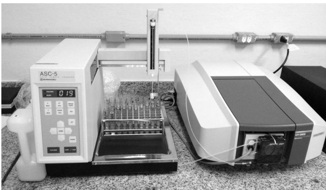
Figura 4. Espectrofotômetro utilizado para as análises da deriva coletada em fios de nylon no túnel de vento.
