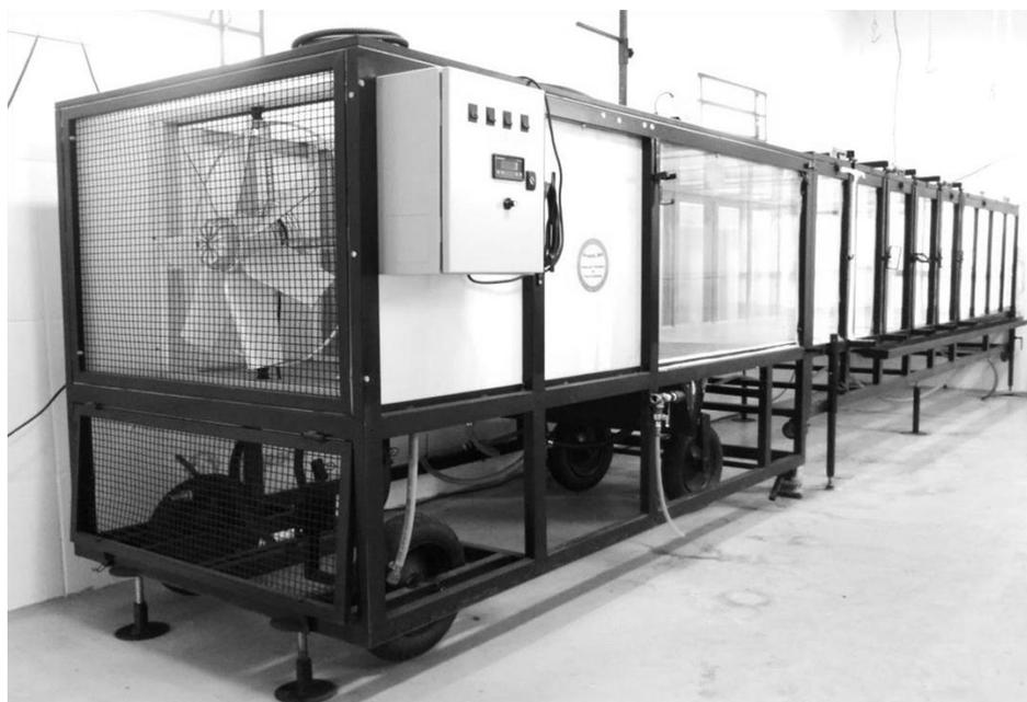
Figura 2. Túnel de vento utilizado para as análises de deriva.
