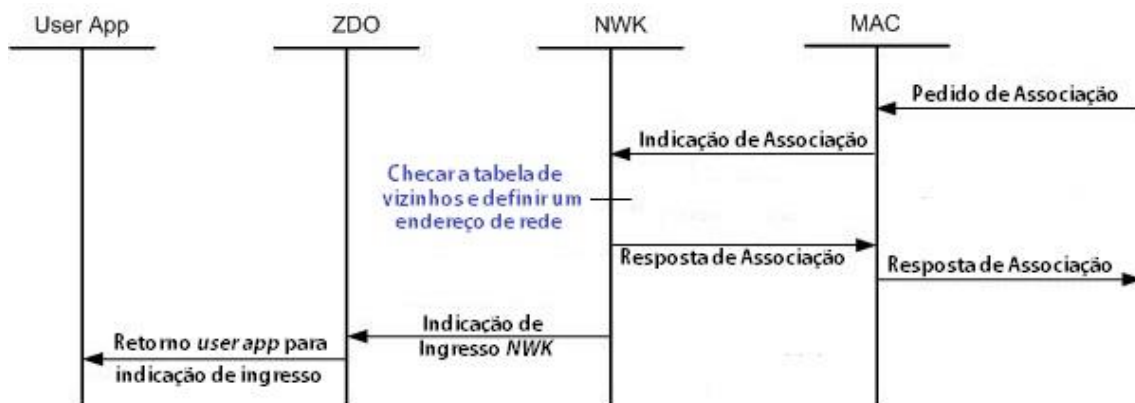
Figura 4.11 – Diagrama esquemático de ingresso de redes ZigBee visto pelo nó pai.
