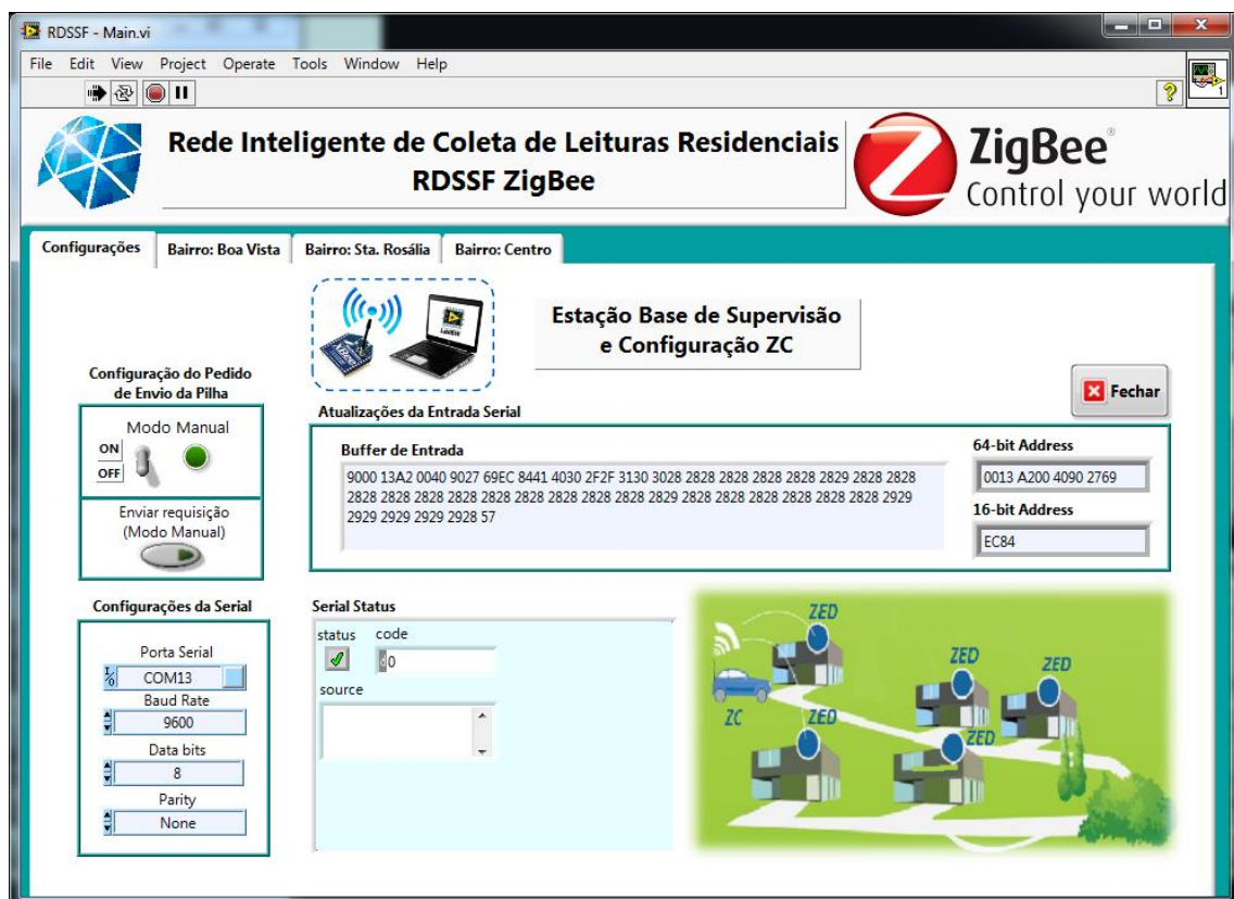
Figura 6.5 – Tela principal de interface ao usuário do sistema de supervisão.
