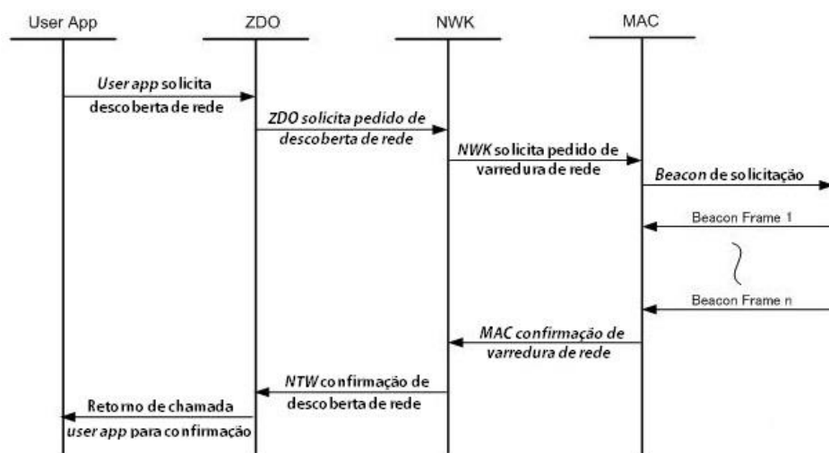
Figura 4.9 – Diagrama esquemático de descoberta de redes ZigBee .
